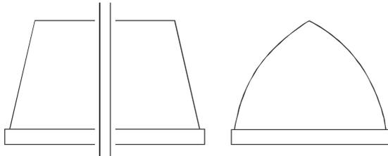
Drucktampons – Serie 600 sind in den Härten 0-30 Shore A standardmäßig auf Holz- Aluminium oder Stahlsockel mit M6 Gewinde erhältlich.
