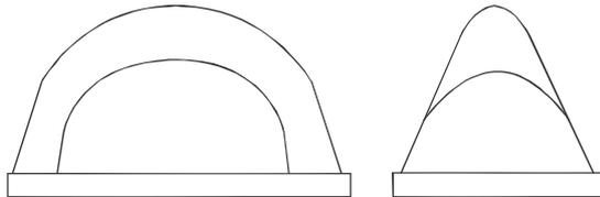
Drucktampons – Serie 500 sind in den Härten 0-30 Shore A standardmäßig auf Holz- Aluminium oder Stahlsockel mit M6 Gewinde erhältlich.
