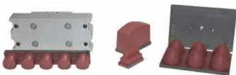
Unter idealen Bedingungen können 50.000 - 100.000 Drucke mit einem Tampon gemacht werden. Dies hängt jedoch von mehreren Faktoren ab: - Druckqualität - Farbserie - Die Form, Größe und Härte des Tampons - Die Form des Druckgutes - Die Struktur des Druckgutes (bei scharfen Kanten und Ecken und einer ungünstigen Oberflächenstruktur, kann die Lebensdauer des Drucktampons drastisch verkürzt werden)
