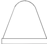
Drucktampons – Serie 300 sind in den Härten 0-30 Shore A standardmäßig auf Holz- Aluminium oder Stahlsockel mit M6 Gewinde erhältlich.
