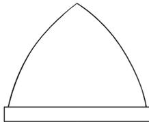
Drucktampons - Serie 100 sind in den Härten 0-30 Shore A standardmäßig auf Holz- Aluminium oder Stahlsockel mit M6 Gewinde erhältlich.
