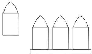
Drucktampons – Serie 900 mini sind in den Härten 0-30 Shore A standardmäßig auf Holz- Aluminium oder Stahlsockel mit M6 Gewinde erhältlich.
