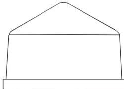
Drucktampons - Serie 200 sind in den Härten 0-30 Shore A standardmäßig auf Holz- Aluminium oder Stahlsockel mit M6 Gewinde erhältlich.
