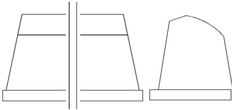
Drucktampons – Serie 850 sind in den Härten 0-30 Shore A standartmäßig auf Holz- Aluminium oder Stahlsockel mit M6 Gewinde erhältlich.
