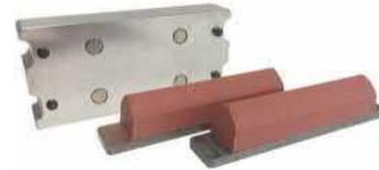
Zusätzlich zu den Standard-Sockeln und Magnetbefestigungen haben wir noch eine Klickhalterung, bei der der Drucktampon direkt auf die Stahlbasis gegossen wird (kundenspezifisch angepasst). Hier kann der Drucktampon in wenigen Sekunden positionsgenau ohne schrauben und neu einrichten mit minimaler Ausfallzeit einfach ausgetauscht werden.
