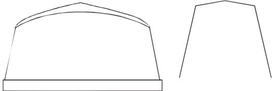
Drucktampons – Serie 400 sind in den Härten 0-30 Shore A standardmäßig auf Holz- Aluminium oder Stahlsockel mit M6 Gewinde erhältlich.
