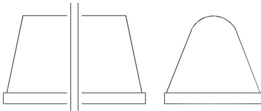
Drucktampons – Serie 650 sind in den Härten 0-30 Shore A standardmäßig auf Holz- Aluminium oder Stahlsockel mit M6 Gewinde erhältlich.
