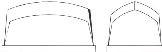
Drucktampons – Serie 550 sind in den Härten 0-30 Shore A standardmäßig auf Holz- Aluminium oder Stahlsockel mit M6 Gewinde erhältlich.
