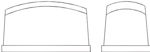
Drucktampons – Serie 700 sind in den Härten 0-30 Shore A standardmäßig auf Holz- Aluminium oder Stahlsockel mit M6 Gewinde erhältlich.
