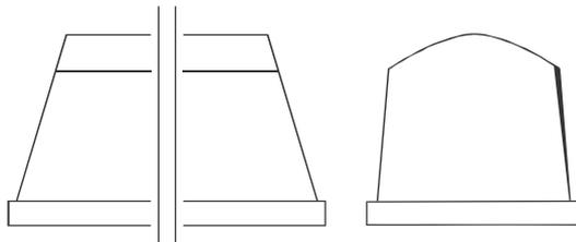
Drucktampons – Serie 800 sind in den Härten 0-30 Shore A standardmäßig auf Holz- Aluminium oder Stahlsockel mit M6 Gewinde erhältlich.
