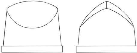
Drucktampons – Serie 350 sind in den Härten 0-30 Shore A standardmäßig auf Holz- Aluminium oder Stahlsockel mit M6 Gewinde erhältlich.
