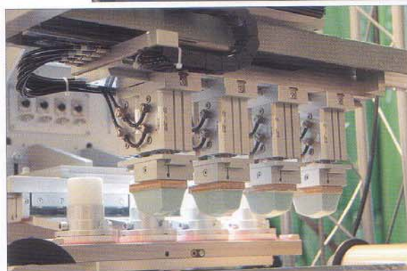
Die ML 350 des Schweizer Herstellers microPrint arbeitet verschleißfrei mit Linear-Motoren. Damit können...
