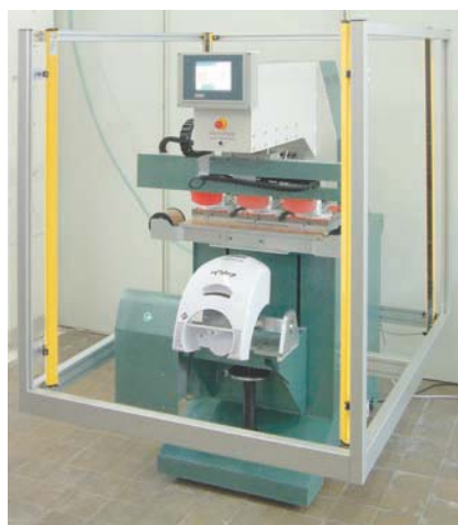
Maschine moderner Bauart mit Antrieb über Linearmotoren – das Bauteil für eine Haushaltsmaschine wird auf fünf Positionen bedruckt.
